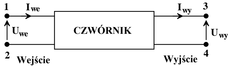
Rys.5 Czwórnik: U_{we} - napięcie wejściowe, U_{wy} - napięcie wyjściowe, K_u = \frac{U_{wy}}{U_{we}} - współczynnik wzmocnienia napięciowego, K_i = \frac{I_{wy}}{I_{we}} - współczynnik wzmocnienia prądowego, R_{we} - oporność wejściowa (między zaciskami 1, 2), R_{wy} - oporność wyjściowa (pomiędzy zaciskami 3, 4).
